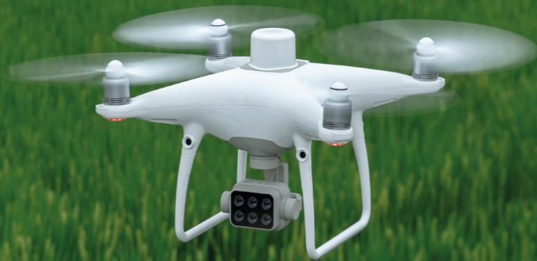
精灵 4 多光谱版是一款配备一体式多光谱成像系统的航测无人机，可采集高精度多光谱数据，助力农业监测与环境监察工作高效完成。
